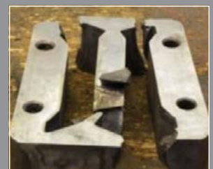
۱.۲۳۷۹/۲ با سختی ۶۰ راکول سی ۱۰/۰۰۰ ضرب تولید ایجاد ترک بعد از
