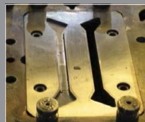
تولاکس ۴۴ + نیتراسیون ۲۵۰/۰۰۰ ضرب تولید کرده و هنوز قابل استفاده است
